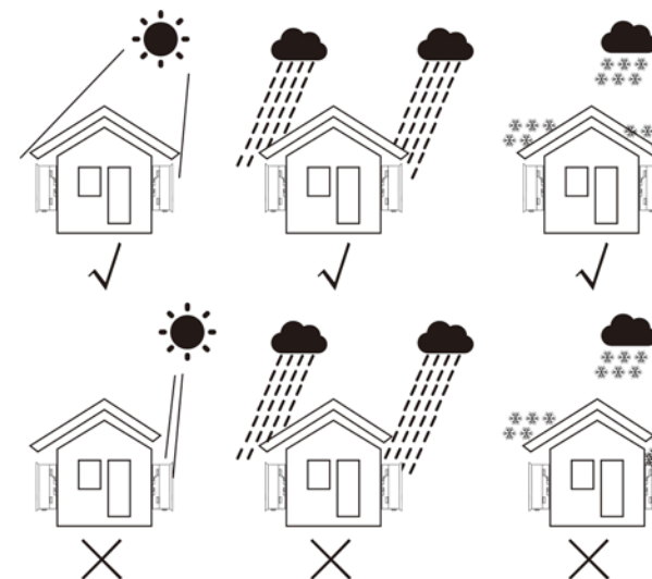
Figura 5.1 Ubicaciones de instalación recomendadas
