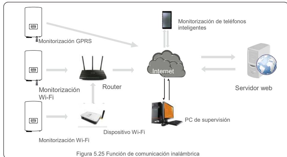
Figura 5.25 Función de comunicación inalámbrica
