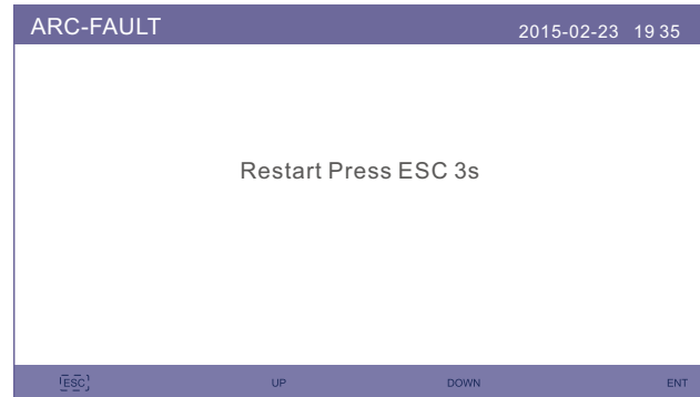
Figura 6.55 FALLO DE ARCO
