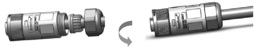
Ilustración 4.17 Apretar la tapa en el terminal
