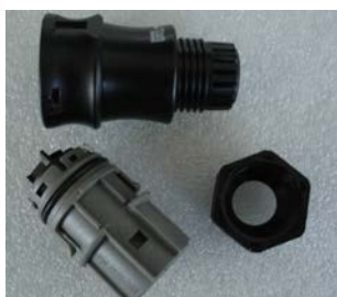
▲ Hình 4.14 Cực nối lưới điện xoay chiều
