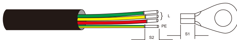
Afbeelding 3.24 De wisselstroomkabel strippen
