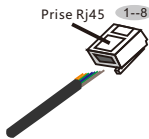
Figure 4.36 Dénuder la couche d'isolation et la connecter à la fiche Rj45
